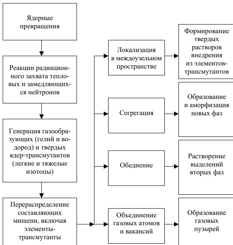
Рис. 3.45. Схема последовательности изменения структурно-фазового состояния реакторных материалов с участием элементов-трансмутантов
