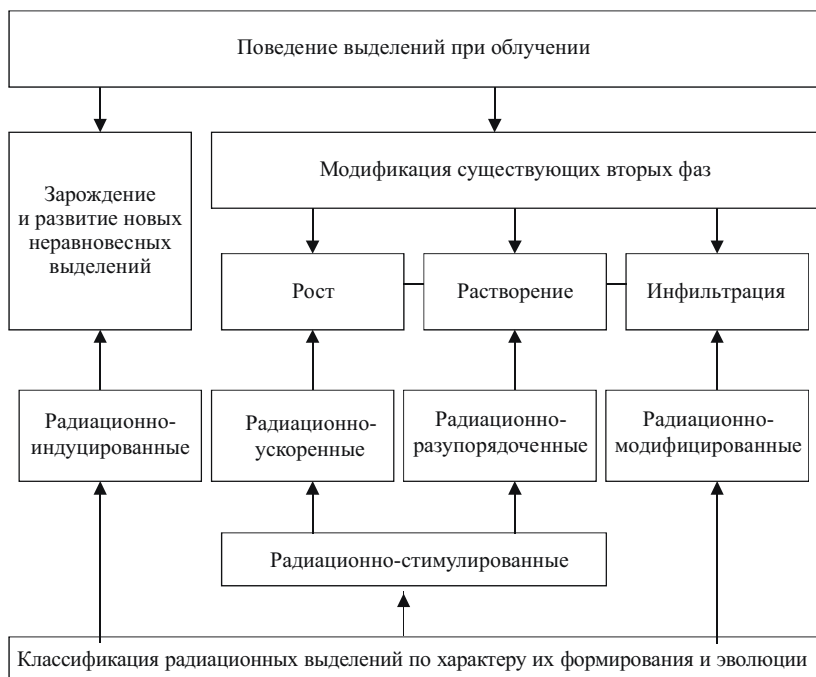
Рис. 3.12. Схема направленной микроструктурной эволюции и классификация выделений при облучении
